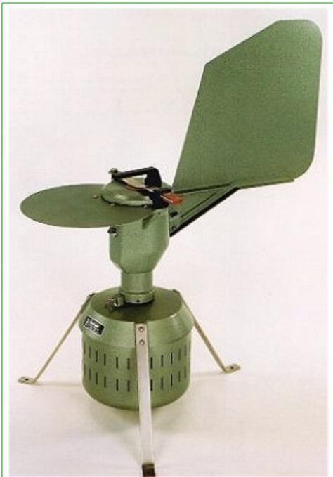
Figura 1.- Recolector de esporas tipo Burkard.
